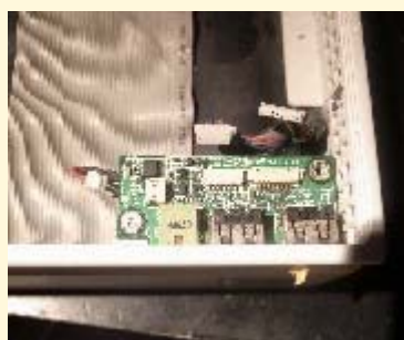
USBポートは外付け基板
